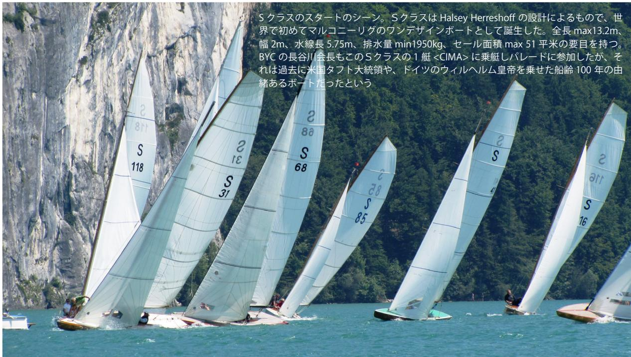
Sクラスのスタートのシーン。Sクラスは Halsey Herreshoff の設計によるもので、世界で初めてマルコニーリグのワンデザインボートとして誕生した。全長 max13.2m、幅 2m、水線長 5.75m、排水量 min1950kg、セーラー面積 max 51 平米の要目を持つ。BYC の長谷川会長もこの S クラスの 1 艇 <CIMA> に乗艇しパレードに参加したが、それは過去に米国タフト大統領や、ドイツのウィルヘルム皇帝を乗せた船齢 100 年の由緒あるボートだったという
