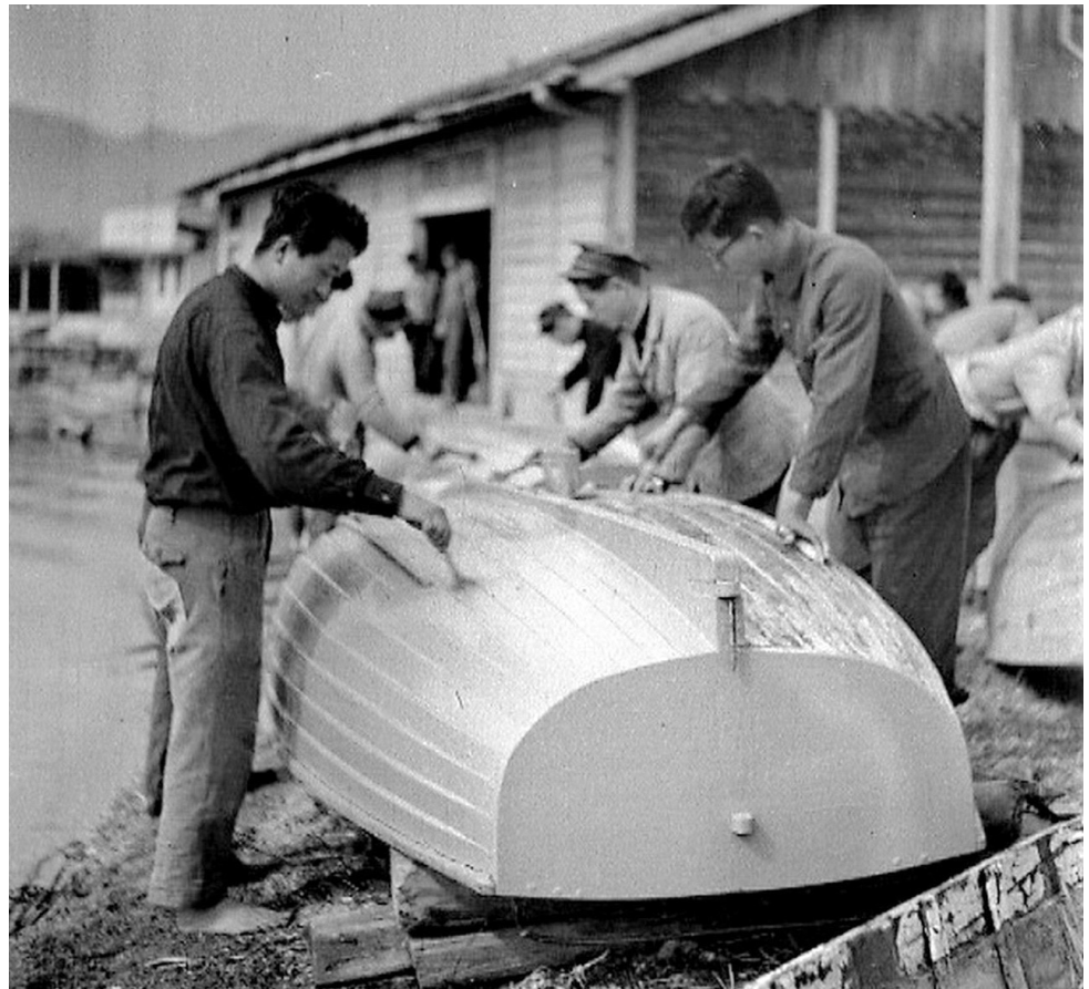
「鷗盟舎」艇庫前でA級の補修作業
