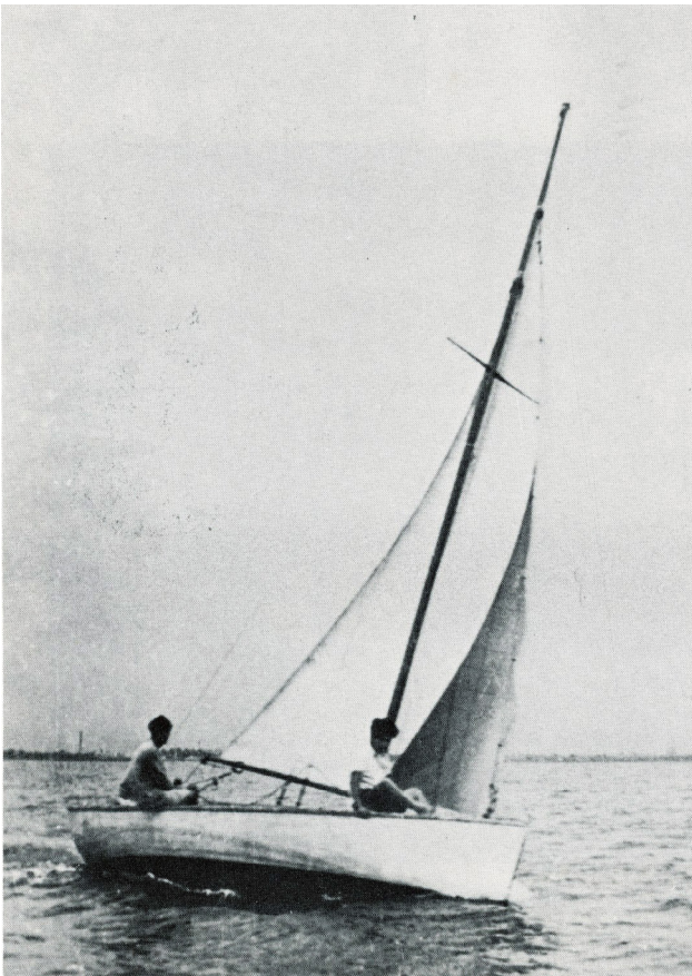
昭和十五年 紀元二千六百年型国内五米艇 レストリクト艇を単一規格化したもの（柳ヶ瀬勉提供）
